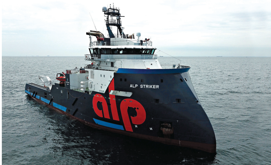
De ALP Striker in 2016 in Japan gebouwd. Trekkraft meer dan 300 ton.
